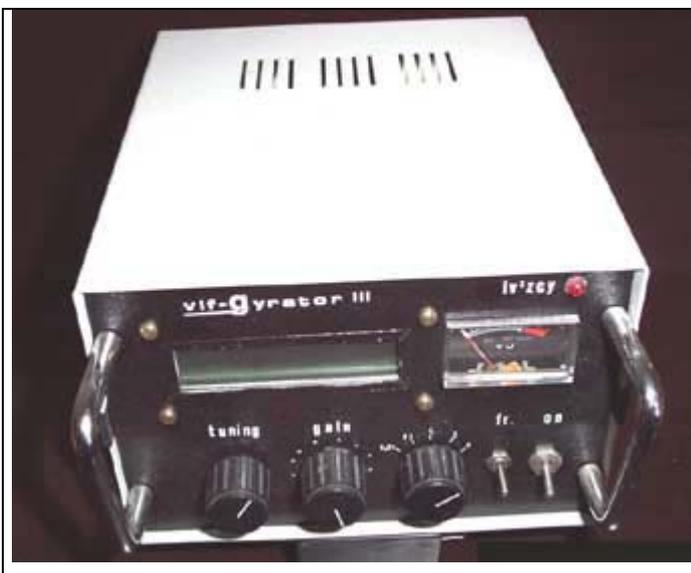
Il ricevitore VLF autocostruito che Giorgio Bressan utilizza per il rilevamento dei SID è dotato di manopole per la sintonia e per il controllo del guadagno. In questo tipo di ricevitore la frequenza portante del segnale trasmesso da una stazione trasmittente VLF viene rettificata ottenendo una tensione positiva proporzionale al segnale ricevuto. Questa tensione arriva a un computer passando per un convertitore analogico/digitale che viene gestito da un software installato sul PC.
